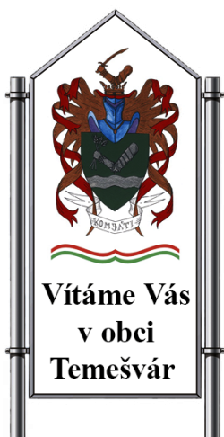
IT-19 Jednostranná uvítací tabule, stojnou část tvoří pozinkovaná ocelová trubka Ø 76 mm, šířka: 1 200 mm, výška: 2 200 mm, k zabetonování. Včetně tabule.
