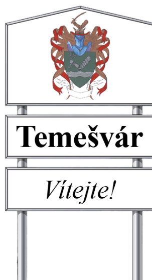
IT-18 Jednostranná uvítací tabule, stojnou část tvoří pozinkovaná ocelová trubka Ø 76 mm, šířka: 900 mm, výška: 2 500 mm, rozměr tabule: 900 x 2 000 mm, horní tabule: 1 200 x 800 mm, dolní tabule: 1 200 x 350 mm, k zabetonování. Včetně tabule.
