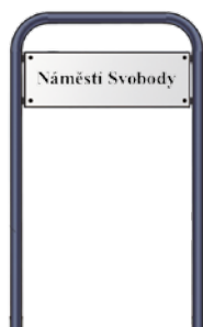
IT-10 Popis názvu ulice na ohýbané konstrukci sloupek z ocelové trubky: Ø 40 x 2 mm, šířka: 700 mm, výška: 1100 mm, velikost desky: 600 x 200 mm, k zabetonování.
