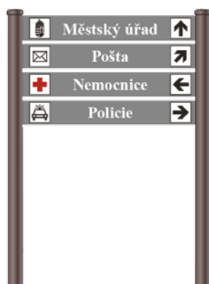
IT-23 Oboustranná navigační deska, sloupek z eloxovaného hliníku Ø 76 mm, šířka: 800 mm, výška: 1 500 mm, velikost desky: 800 x 125 mm, k zabetonování.
